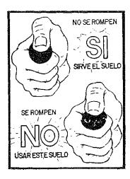
Estas pruebas son muy importantes para controlar la calidad del barro que se va a utilizar en la construcción, para asegurar una estabilidad de la vivienda. Los refuerzos de caña se colocan horizontal y verticalmente; éstos deben someterse a un tratamiento de impermeabilización para evitar que sean atacados por humedad y pierdan resistencia.
